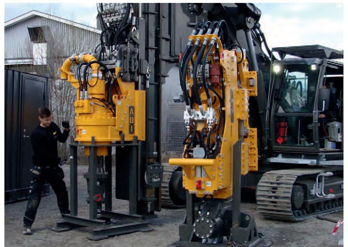
*Bilder: Vorfürungen von Docking-System an der neuen TM 11/14 SL aus dem SPD AB Mietpark (oben) und Bohrmäkler DT 145 und Rohrgreifer von SPD AB (unten)*
