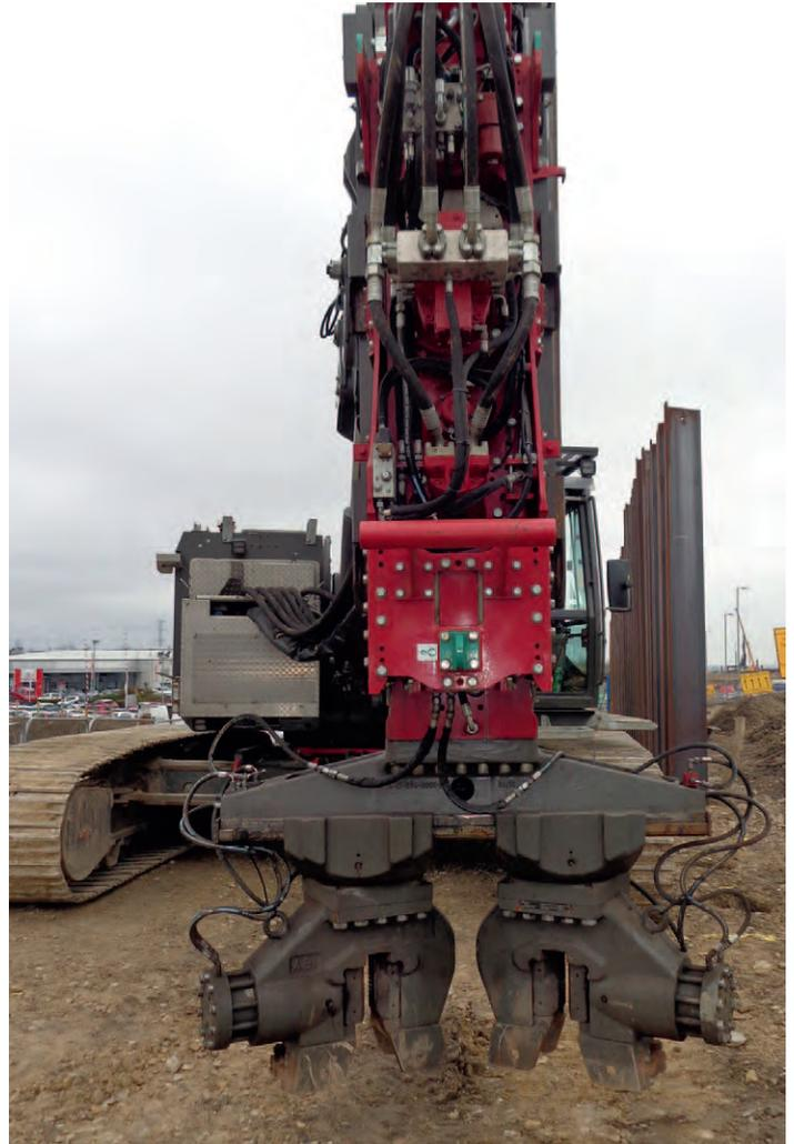
*Bilder: ABI Kombiklemmzange MZK 1200 angebaut am Vibrator MRZV 30VV (oben)
